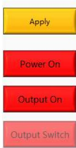
图 5-8 “Output Switch” 被禁用
